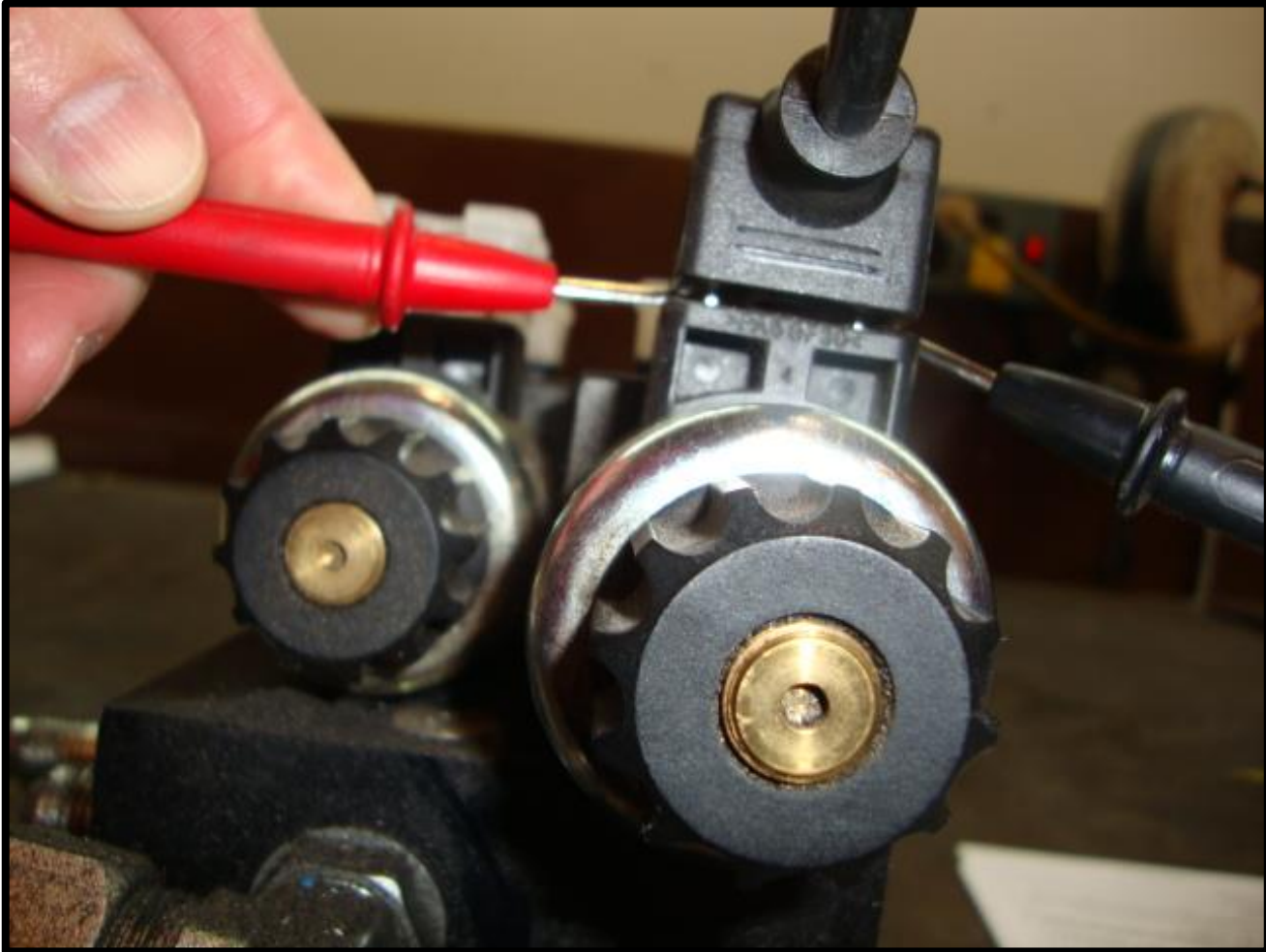
Fig. 8-4 Checking Din Plug Voltage
