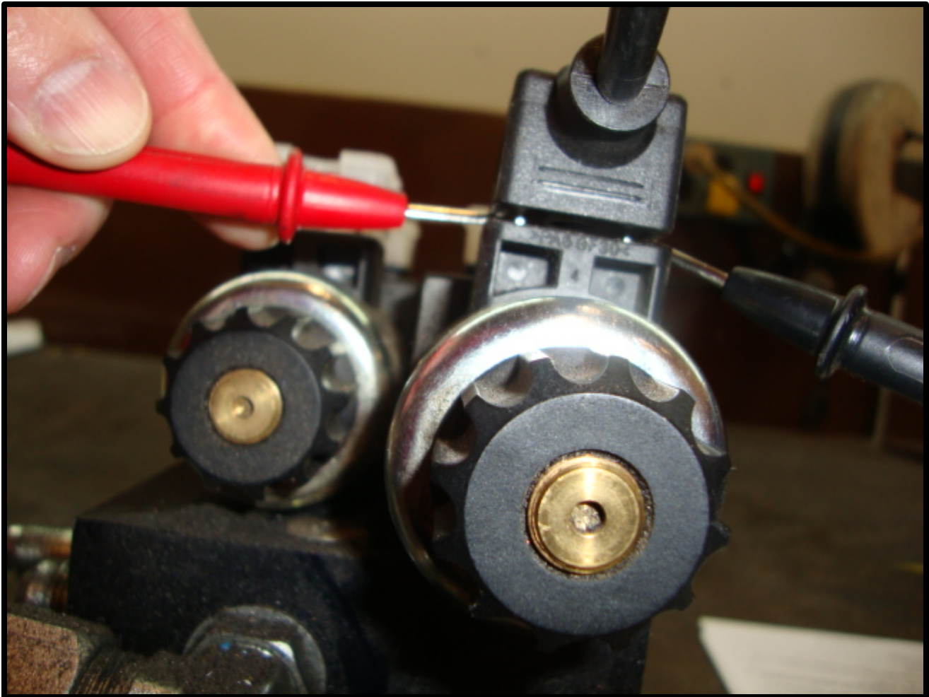
Fig. 8.4 Checking Din Plug Voltage
