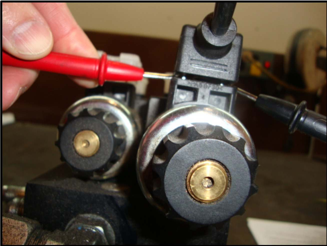
Fig. 8.4 Checking Din Plug Voltage
