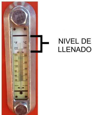
Figura 5-2 Nivel de Fluido Hidráulico e Indicador de Temperatura
